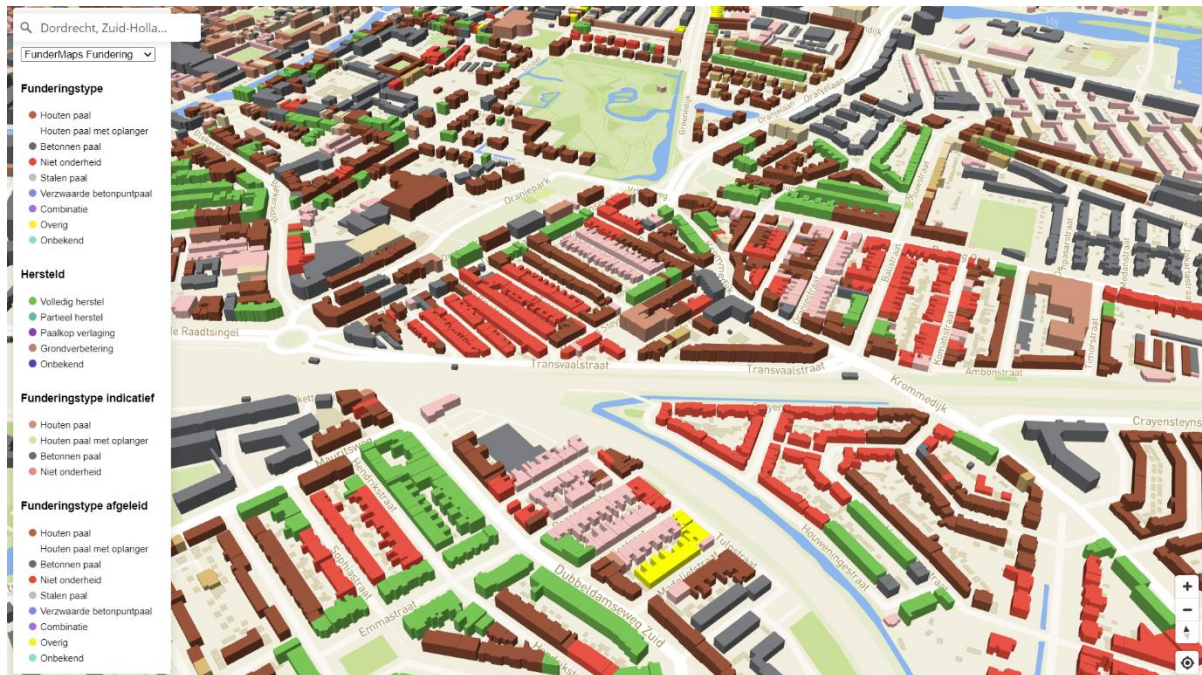
Figuur 5; Kaartweergaven funderingstype vastgesteld, afgeleide bepalingen, herstelde funderingen en aangevuld met modelmatig bepaalde funderingstypes (© FunderMaps).
