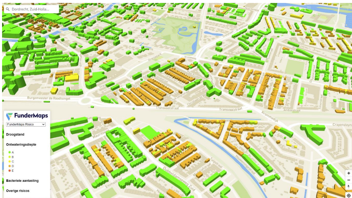
Figuur 9; Kaartweergave Risico op Ontwateringsdiepte (© FunderMaps).
