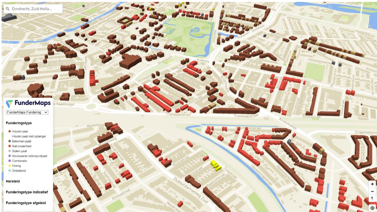
Figuur 3; Kaartweergaven funderingstype vastgesteld op basis onderzoeksgegevens (© FunderMaps)
