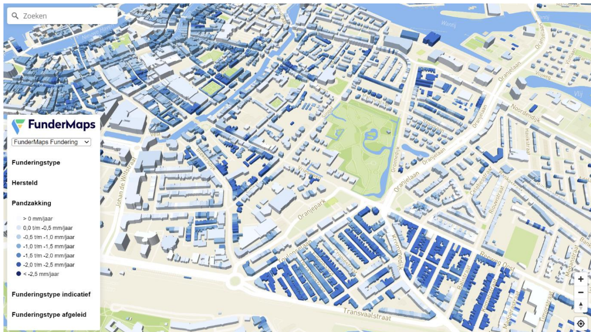
Figuur 13; Kaartweergave pandzakking / verschilzakking (© FunderMaps).
